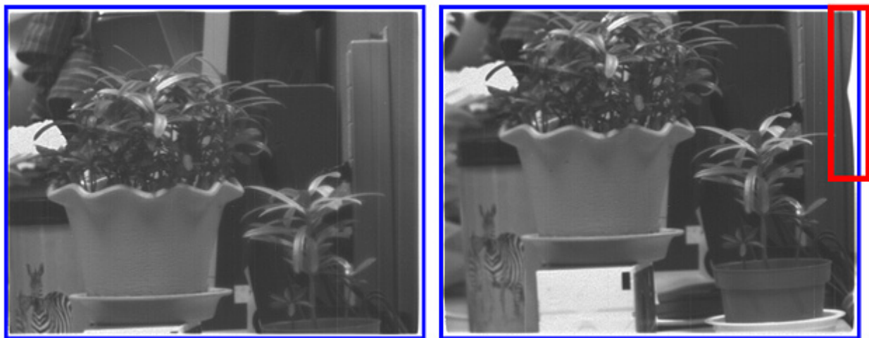
圖3、(a)正常模式下取得之影像；(b)雜訊源以10 MHz 操作下所取得的影像
